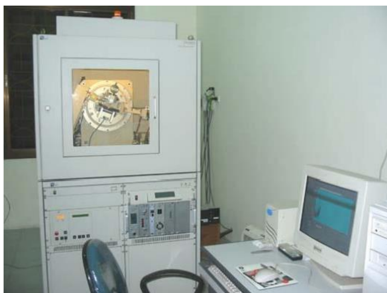
Hình 2.4: Thiết bị máy đo nhiễu xạ tia X SIEMENS D5005, Khoa Vật lý,
