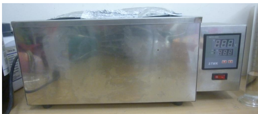
Hình 2.13: Hệ thống kiểm soát nhiệt độ XMTD – 6006, khoa Vật lý, trường Đại học Khoa học Tự nhiên
