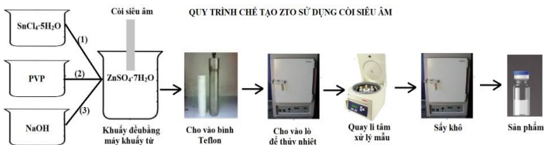
Hình 2.2. Quy trình chế tạo vật liệu ZTO sử dụng siêu âm
