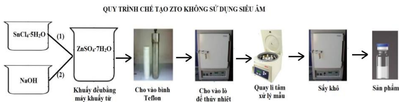
Hình 2.1. Quy trình chế tạo vật liệu ZTO không sử dụng siêu âm
