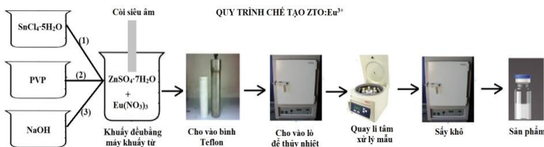
Hình 2.3. Quy trình chế tạo vật liệu ZTO:Eu 3+ sử dụng siêu âm
